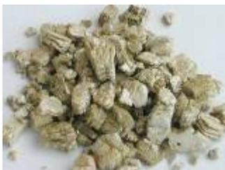
La vermiculite expansée est un silicate d'alumine et de magnésie. Elle est d'origine naturelle, mais produite par chauffage à des températures telles que le matériau ne fond pas mais se dilate. La vermiculite est une sorte de "mica" expansé et se décompose facilement en feuillet. Ce matériau est très bien pour alléger un substrat, pour lui donner une consistance moins compacte. Il vieillit néanmoins assez rapidement et se tasse, il sera donc
