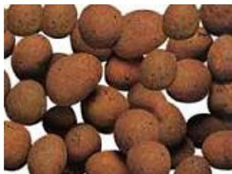
L'argile expansée est produite de la même manière que la vermiculite, mais à partir d'un autre silicate, une argile fibreuse (attapulgite). L'argile expansée est vendue sous forme de sphère de diamètre variable et il faut souvent réduire au marteau celle que l'on trouve facilement dans le commerce.
